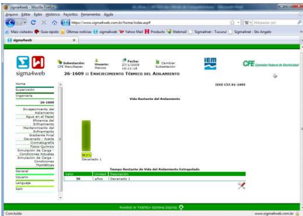
Fig. 7 – Pantalla típica de diagnóstico del sistema de monitoreo
