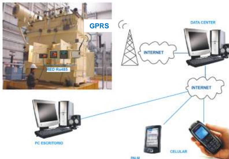
Fig. 2 – Arquitectura de Comunicación del Sistema de Monitoreo
