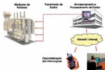
Figura 1 – Topologia típica de um sistema de monitoração
