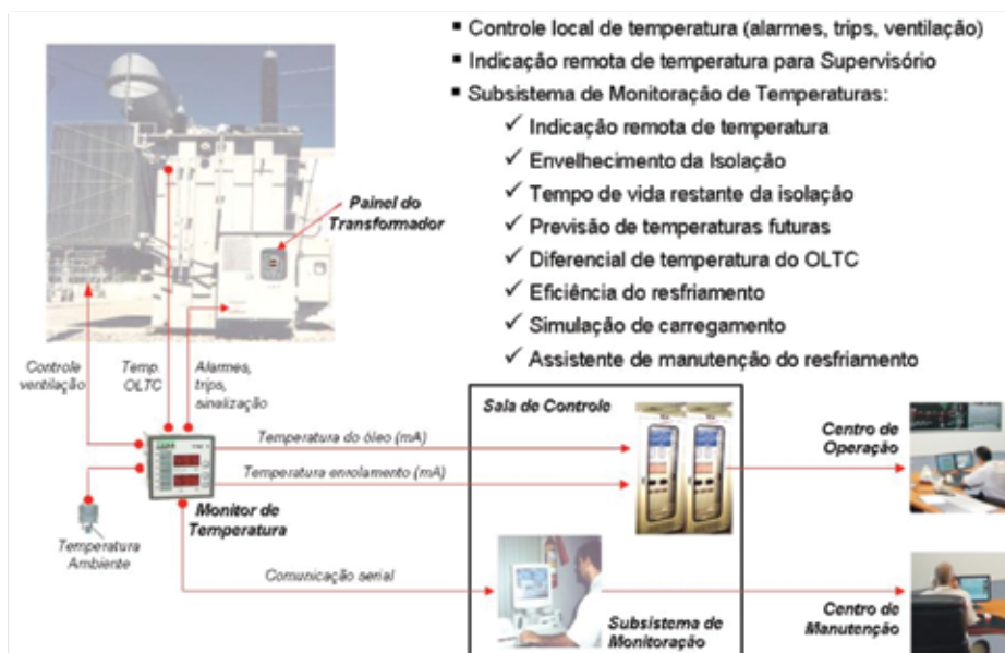
Figura 4 – Subsistema de monitoração de temperaturas
