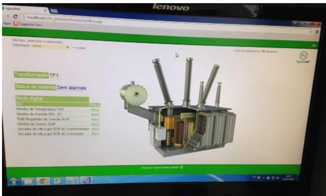
Fig. 08 - Tela do software de monitoramento com o sistema de identificação visual de falhas no transformador
