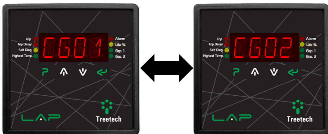
Figura 35 - Navegação entre grupos de resfriamento
