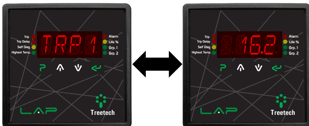
Figura 25 - Indicação de contagem regressiva para desligamento
