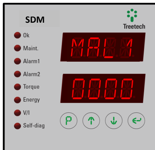
Figura 65 - Indicação de alarme no SDM
