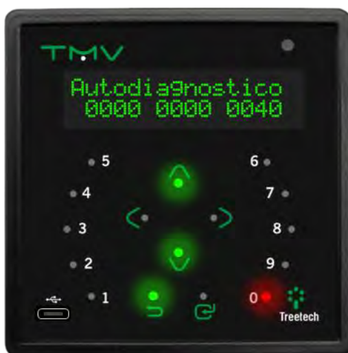
Figura 35 - Indicação de autodiagnóstico
