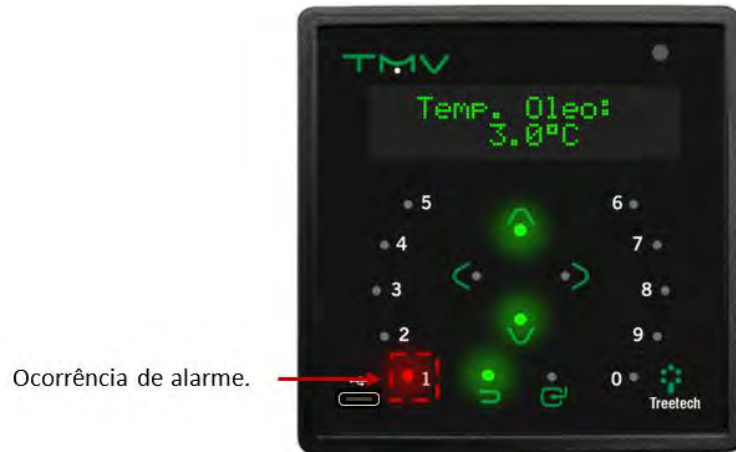
Figura 29 - Indicação de alarme gerais
