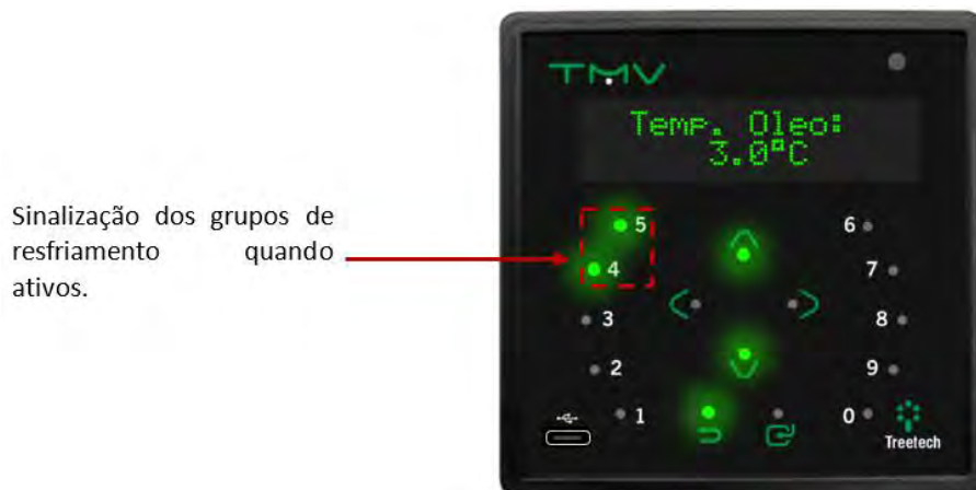
Figura 24 - LEDs dos grupos de resfriamento 1 e 2
