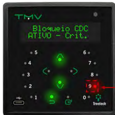
Figura 32 - Alarme de Bloqueio do CDC
