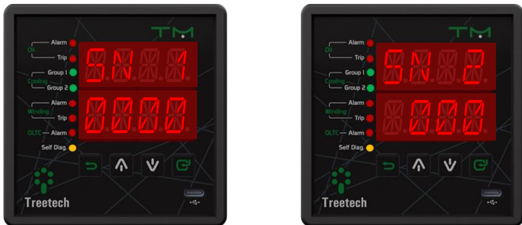
Figura 17 - Display indicando parte 1 e parte 2 do número de série
