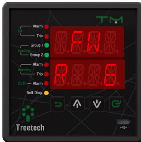
Figura 13 - Display indicando versão de release do firmware
