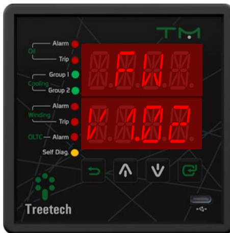
Figura 12 - Display indicando versão de firmware
